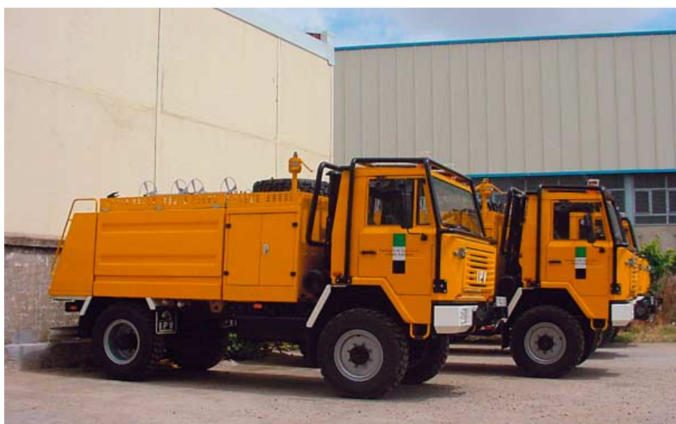
Vehículo motobomba pesado cabina simple.
