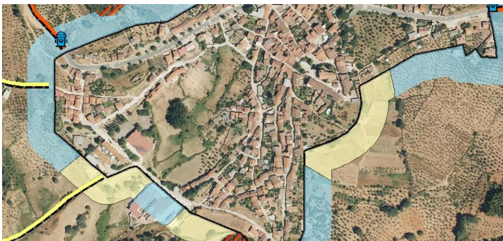
Banda mal diseñada, con amplias superficies agrícolas y forestal en contacto con infraestructuras
